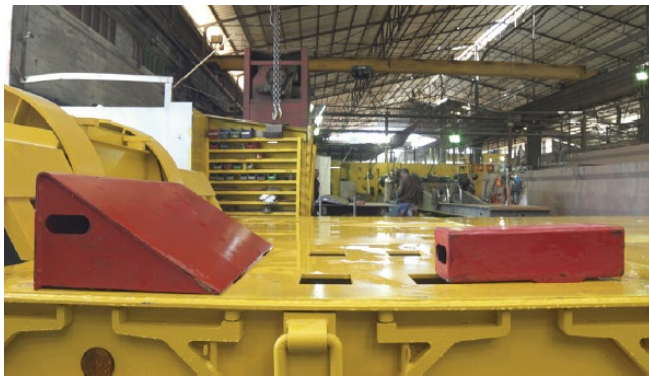
סדי עצירה רוחביים וקדמיים משמשים למרכז וריסון מטען כבד על מרכב הרכב
